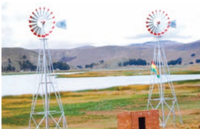
Foto 1.2 Aerobombas en paralelo Localidad: Escoma - La Paz
