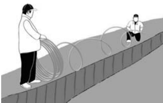
Fig. 1.2 Forma incorrecta de desenrollar la tubería
