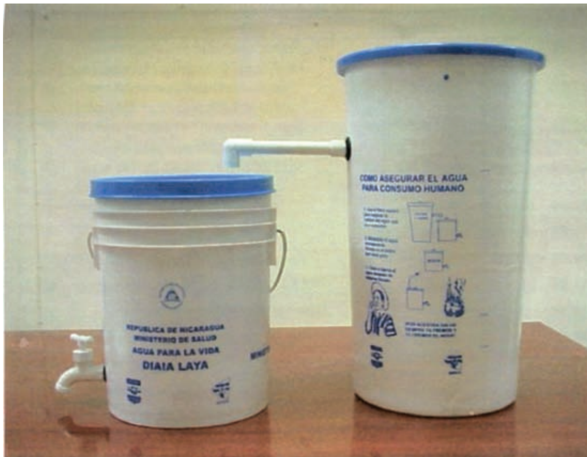
Foto 1.1. Filtro casero de arena.
