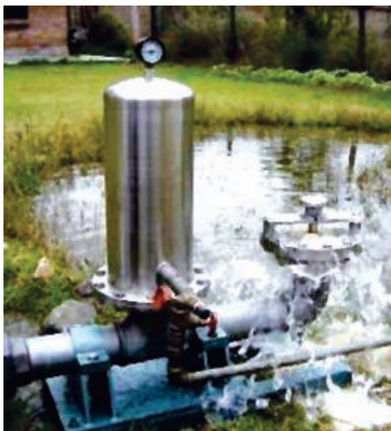
Foto 1.1 Bomba de Ariete en funcionamiento
