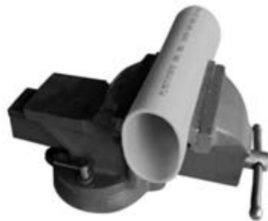
Foto 2.1 Prueba de impacto y compresión a la tubería
